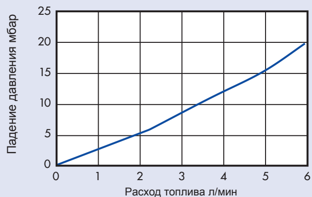
Гидродиаграмма сопротивления фильтра SWK 2000/5/50/H
