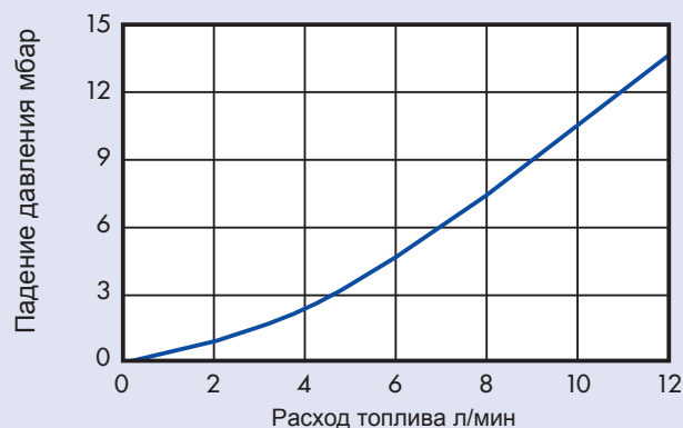
Гидродиаграмма сопротивления фильтра SWK 2000/10/H
